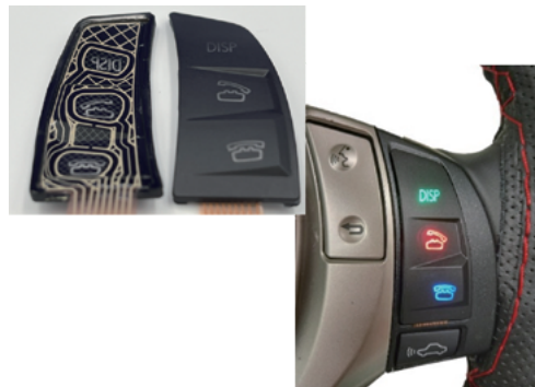
■ 図2 静電容量型立体スイッチ（基材：ポリカーボネート）
